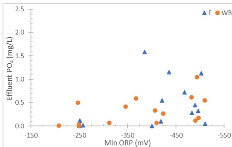
Figure 4.5.1.1: Minimum anaerobic ORP vs effluent  $\text{PO}_4$
