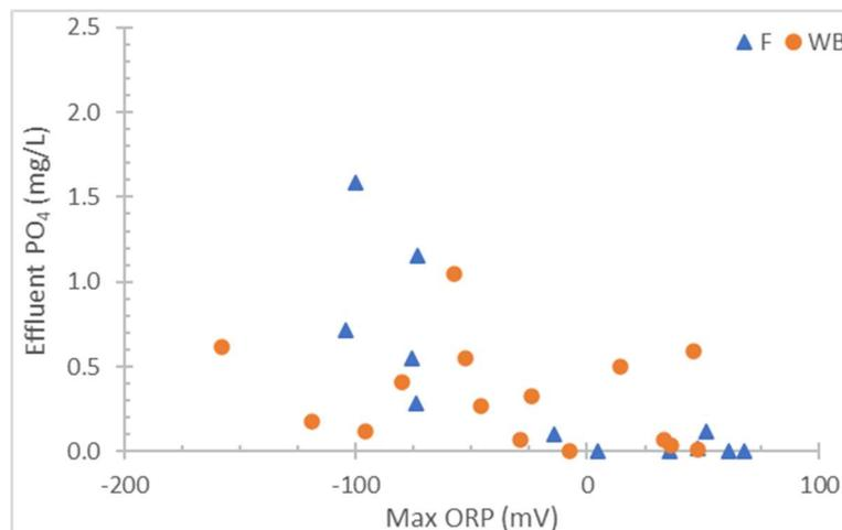
Figure 4.5.1.2: Maximum aerobic ORP vs effluent PO<sub>4</sub>
